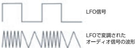
補助的なコンポーネントの最後は、ロー・フリクエンシー・オシレーター、略してLFOです。LFOの動作は基本的にはメインのオシレーターと同じですが、出力するのは非常に低い周波数の信号です。LFOは一般的にモジュレーション用のコントロール信号を出力し、メインのコンポーネントに配線されます。例えば、6HzのLFO信号をオシレーターに配線すれば、オシレーターのピッチを6Hzの信号で揺らすこととなり、いわゆるビブラートになります。同じLFOの信号をアンプに配線すれば、音量が周期的に変化するトレモロになります。このようにLFOは周期的な変化を音に与え、音色をよりダイナミックで面白いものに変える役割を担っています。
