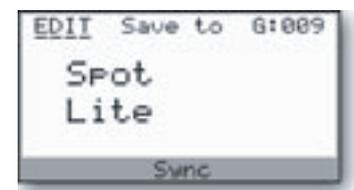
[CURSOR] ボタンでセーブ先のバンク、ロケーションにカーソルを移動でき、[-1]/[+1] ボタンでバンク、ロケーションを変更できます。セーブしたいバンク、ロケーションを選択し、[ENTER] ボタンを押すと、セーブの最終確認を行う(「YES」または「NO」を選択する)画面が表示されます。[CURSOR] ボタンで「YES」を選択し、[ENTER] ボタンを押すと、セーブが実行されます。なお、MIDI CCメッセージでエディットされたプリセットはセーブされませんのでご注意ください。
