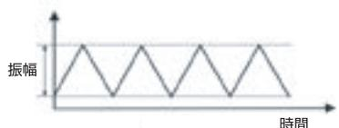
音には、他にも要素と言えるものがあり、音の大きさ(音量)もそのひとつです。大きな音というのは、気圧の変動を大きくします。逆に小さな音は気圧の変動が小さい状態です。この気圧の変動を「振幅」と呼び、その大きさをデシベル(dB)という単位で計測します。
