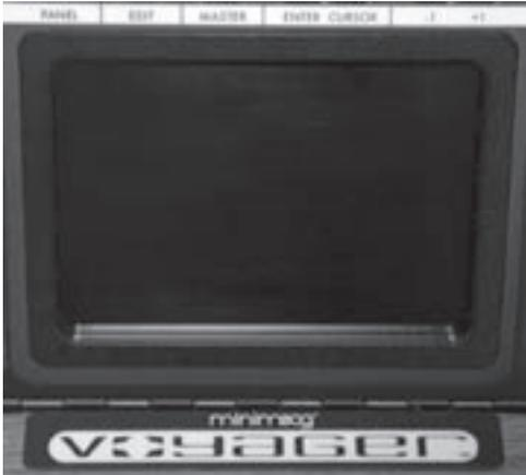
タッチ・サーフェス・コントローラーはリアルタイムに操作できる3次元コントロール・サーフェスです。指先の動きやタッピングなどでVoyagerのサウンドを複雑に変化させることができます。左右方向のX軸、上下方向のY軸、指先がタッチ・サーフェスに触れている面積 (A : エリア) の他に、タッチすることでゲート信号を出力しますので、合計4種類 (X、Y、A、ゲート) の信号を出力し、Voyagerの様々なパラメーターをコントロールできます。
