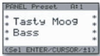
プリセットをエディットした後で、再び元のプリセットに戻りたい場合は、(ENTER)ボタンを押します。また、元のプリセット(メモリーされているプリセット)とエディット中の音色は、(EDIT)ボタンを押し、「Compare to Preset」機能を選択すると2つの音色(プリセットとエディット中の音色)が交互に切り替えて聴き比べることができます。この機能を選択し、(CURSOR)ボタンを押すと2つの音色が交互に切り替わります(「Compare to Preset」機能の詳細につきましては、43ページをご参照ください)。エディットした音色を保存したい場合は、(EDIT)ボタンを押して「Save Preset」機能を選択します(「Save Preset」機能の詳細は、53ページをご参照ください)。プリセットをエディットし、セーブせずに別のプリセットを選択すると、エディットした内容は消去されてしまいますのでご注意ください。
