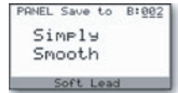
一方エディット・モードでは、前回セーブしたバンク、ロケーションがセーブ先のデフォルト表示になります。例えば、前回セーブしたのがバンクGのロケーション9番だった場合、エディット・モードでのセーブ先のデフォルト表示はバンクGのロケーション9番になります。なお、指定したメモリー・ロケーションにセーブされているプリセット名は、誤って上書きしてしまうことを防ぐため、常に表示されます。
