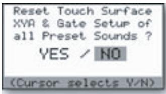
タッチ・サーフェスXYAGデスティネーション機能は、タッチ・サーフェスの各コントロール信号(X、Y、A、ゲート)のデスティネーション設定、MIDI CCナンバーの割り当て、ディレクション設定、アマウント設定をデフォルト設定に戻す際に使用します。各設定のデフォルト値は次の通りです：
