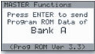
SEND・システムROM機能は、Voyagerのオペレーティング・システムをSysExデータの形式でバックアップを取れる機能です。この機能を実行するには、MIDIインターフェイスを装備し、マニュアルSysExダンプを受信できるプログラムをインストールしたコンピュータが必要になります。コンピュータでSysExを受信する準備が整いましたら、[ENTER]ボタンを押して送信を始めます。データ送信が始まると、Voyagerのディスプレイには「SYSTEM EXCLUSIVE DATA IN PROGRESS」(システム・エクスクルーシブ・データ送信中)のメッセージと、進行状況を示すバー・グラフが表示されます。データ送信が完了すると、Voyagerのディスプレイは次のバンク(バンクC)のデータを送信する画面が表示されます。コンピュータを再びSysExを受信できる状態にし、[ENTER]ボタンを押すとバンクCのデータ送信が始まります。データ送信が完了すると、Voyagerのディスプレイはマスターモードのメニュー画面に戻ります。
